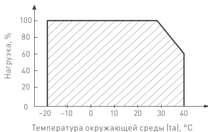
Рис. 2. Максимальная допустимая нагрузка, % от мощности источника
